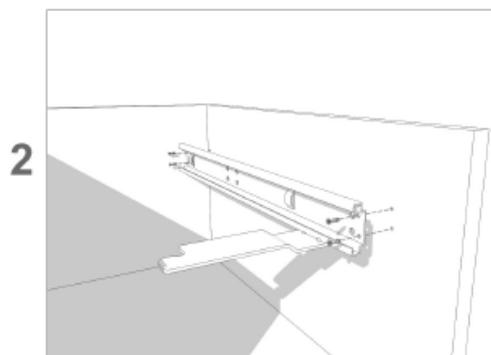
Applicare e fissare la guida esterna destra al mobile (riconoscibile dalla piastra saldata perpendicolarmente).
