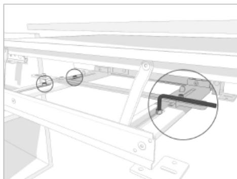
Alzare l'asse da stiro dalle guide e allentare i bulloni indicati in Fig.5 per permettere la regolazione delle guide stesse.
