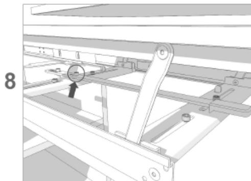
Regolare l'asta di bloccaggio sfilando verso l'esterno l'asse e allentando il bullone indicato in Fig.8 e posizionare il fermo nella posizione ottimale per il bloccaggio(Fig.8A).
